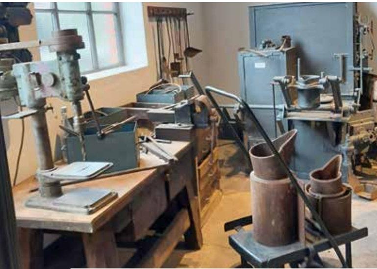
Nachgestellter Werkstattbereich im DDM, hier in Form einer Gießerei zum Ausgießen der Gleitlager an Dampflokomotiven.
