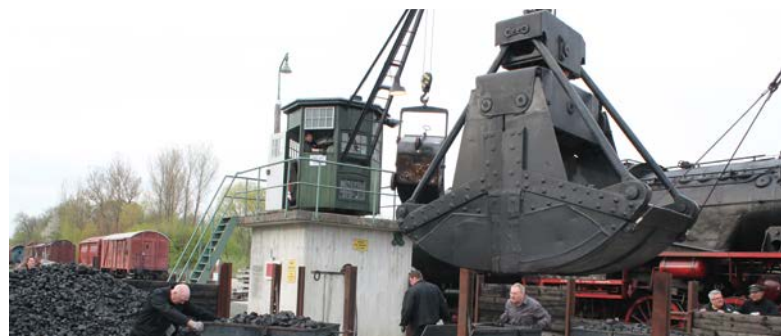
Der Ruge-Kran im Einsatz beim Bekohlen der 52 8079
